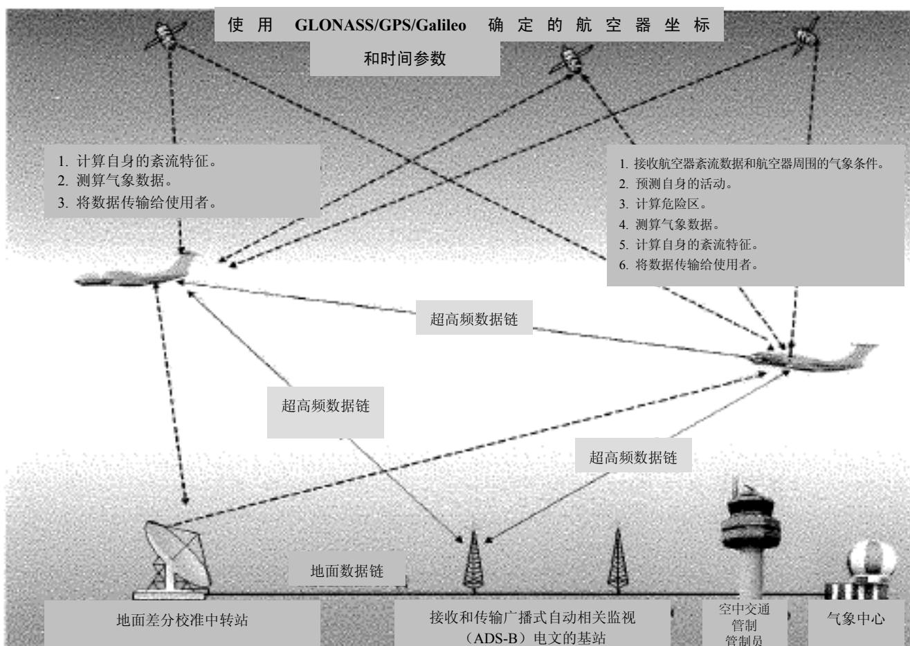
5.2 航空器和地面空中交通管制(ATC)中心所使用的仪表方法以及预测运算法则可被用来预测涡流的状况。在驾驶舱的显示器上可以提供涡流的目视显示，向驾驶员提供所需的尾流紊流信息以便进行必要的有效机动，防止航空器遭遇尾流紊流。
