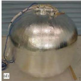
(d) PUF Insulation and Water-resistant Taping
