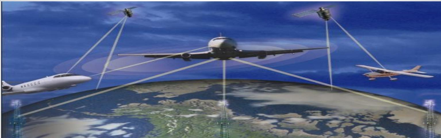
通过接收附近半径数十公里以内的民航客机广播的 ADS-B 信号，分析每台客机的位置、高度、速度等信息，分析双方危险接近和碰撞的风险，并在判断存在碰撞风险的情况下主动避让，大大提升了飞行安全系数。
