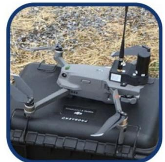
6.15 Bajo la IP/35, México informó que Servicios a la Navegación en el Espacio Aéreo Mexicano “SENEAM” adquirió una flota de 11 drones para realizar operaciones de calibración, ajuste, supervisión y control en tiempo real de las radioayudas VOR e ILS emplazadas en aeropuertos. Esto fue para mantener las operaciones de navegación, aproximación y aterrizajes aeropuertos con los más altos estándares de seguridad operacional.
