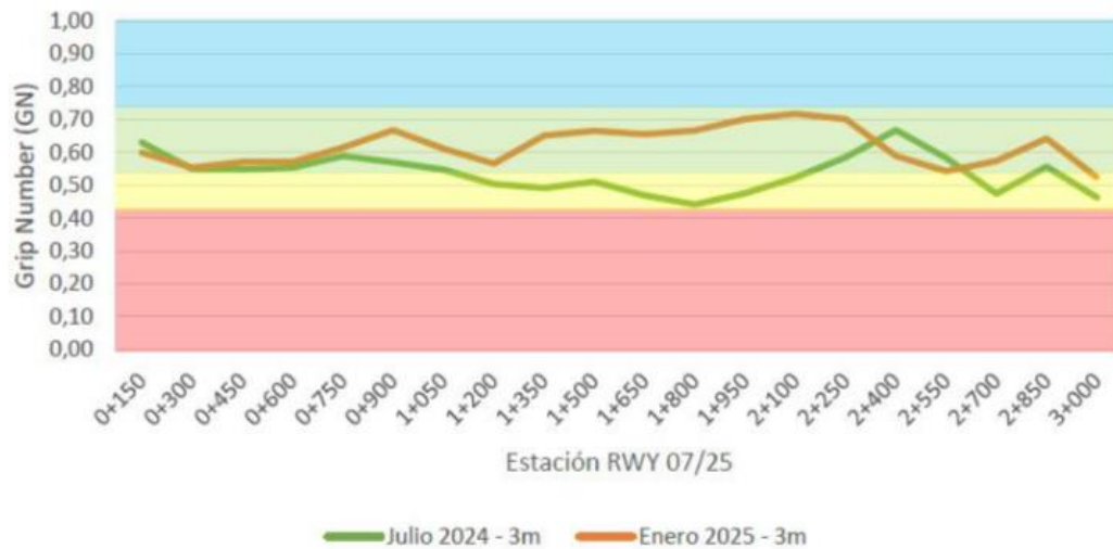
Comparación de la fricción antes y después del ranurado – 3 m a cada lado del centro de pista
