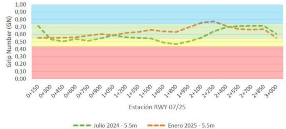
Comparación de la fricción antes y después del ranurado – 5.5 m a cada lado del centro de pista
