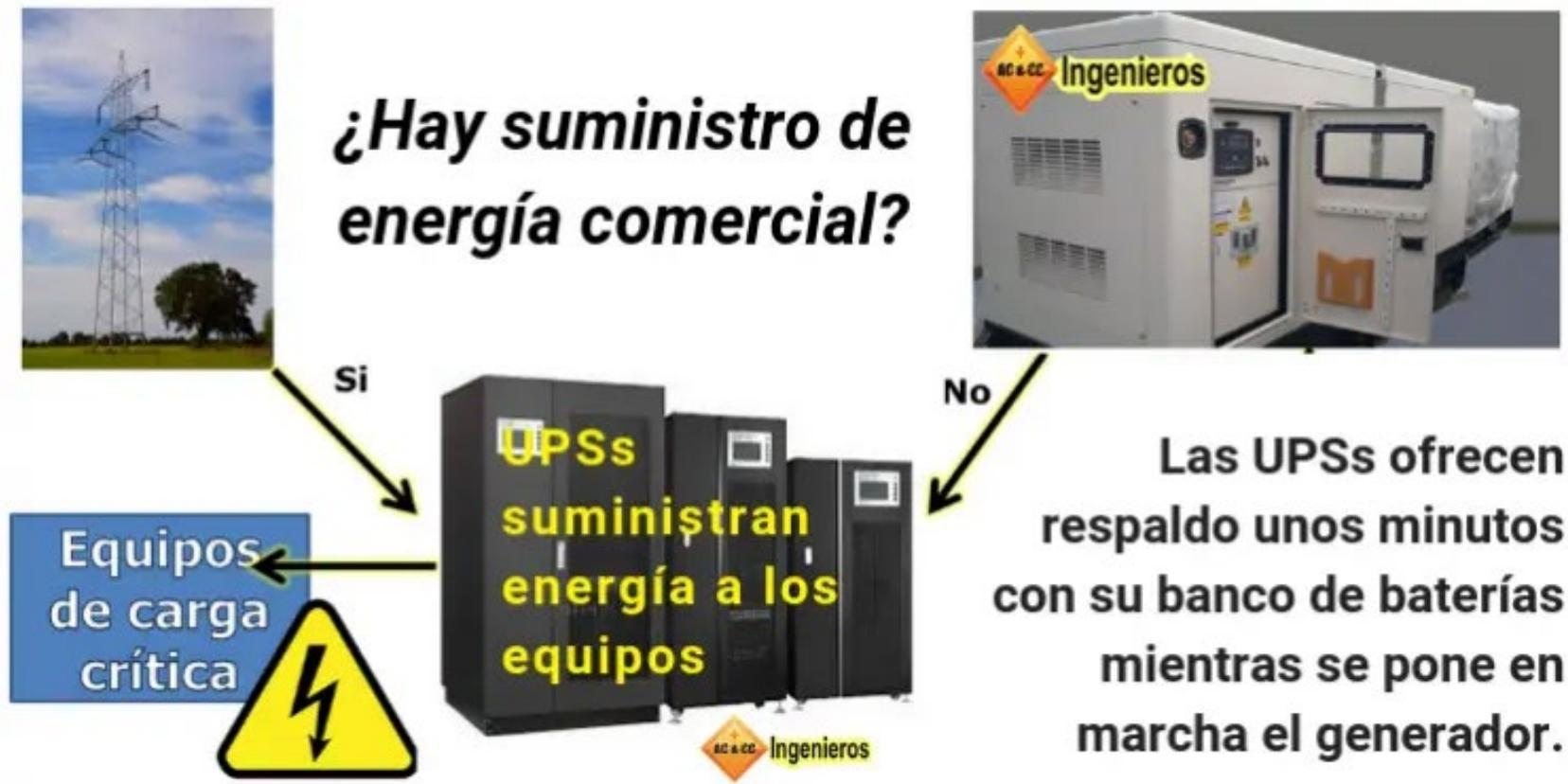
Considere UPS redundantes y con capacidad de respaldo suficiente, en potencia y en tiempo de respaldo, para fallos en la automática de los grupos electrógenos.
