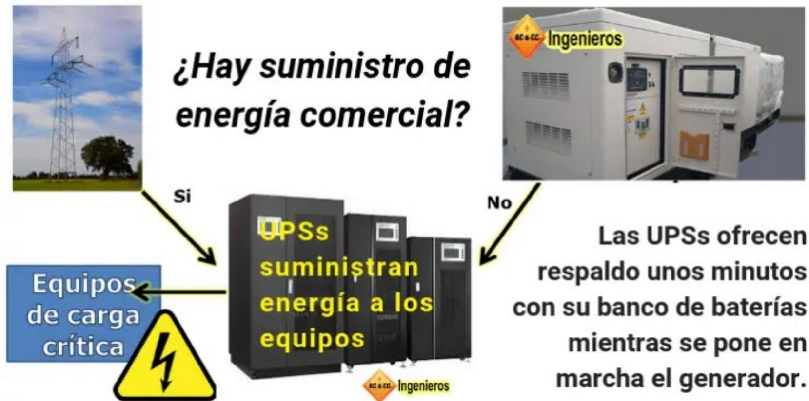
No dependa de un punto de falla sencillo, ya sea un cable o un conectivo en el soporte eléctrico de la carga crítica.
