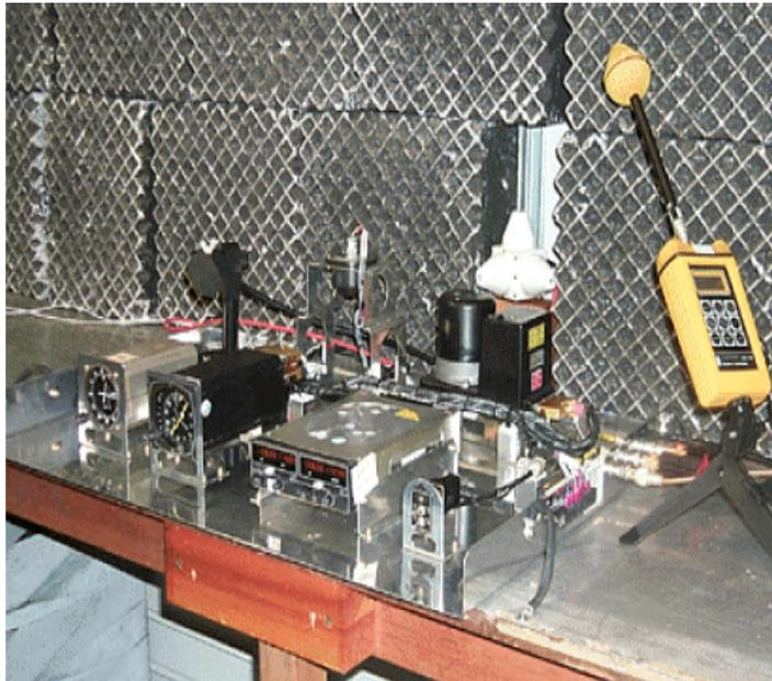
Exemple d'installation pour des essais d'EMI (susceptibilité et émission d'énergie non essentielle)
