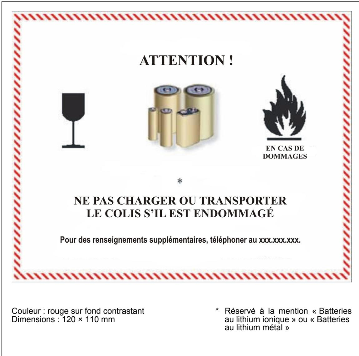
**Figure 5-30. Étiquette de manutention « Batteries au lithium »**
