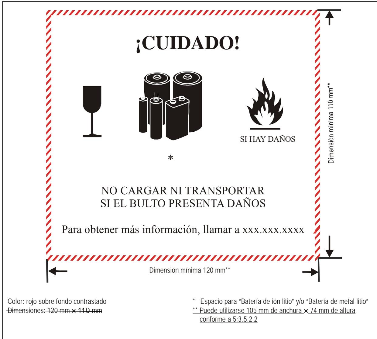
Figura 5-3432. Etiqueta de manipulación de baterías de litio
